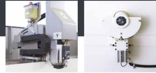
Almacén de herramientas de 5 posiciones en la máquina, con cambio automático de herramientas
