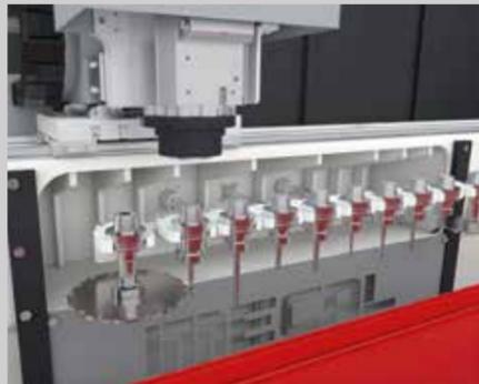
Posicionamiento simultáneo de las mordazas La motorización independiente permite el posicionamiento autónomo de cada mordaza en un equipo extremadamente corto
