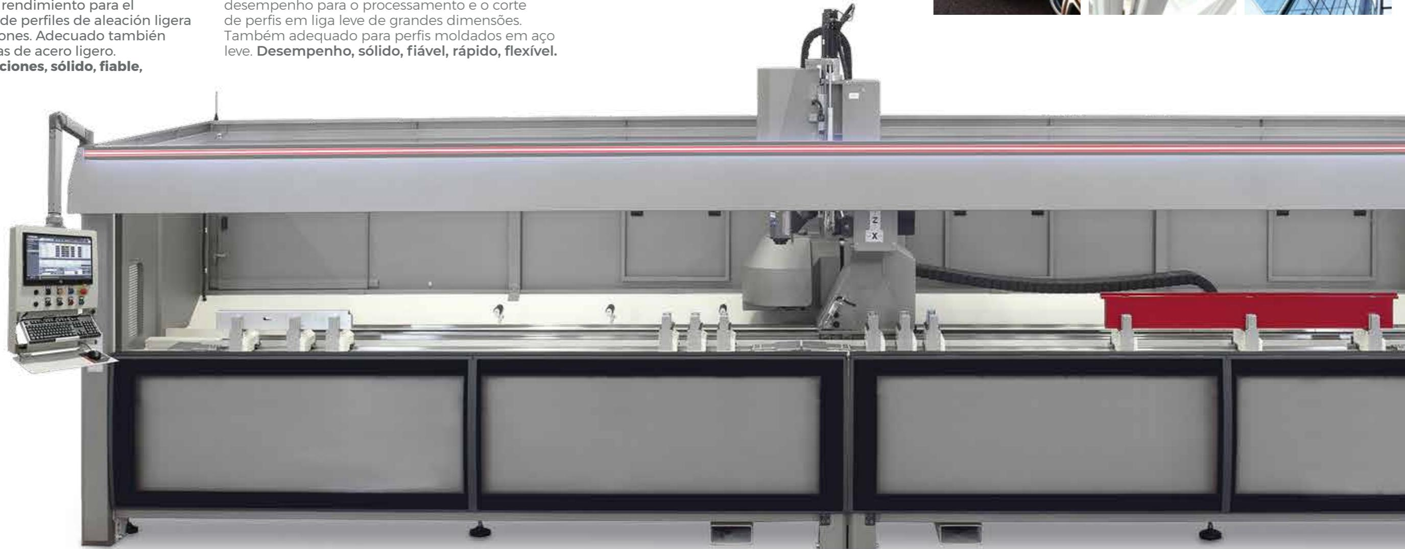
La zona de mecanizado longitudinal se puede gestionar como campo único o con campos complementarios (ciclo pendular). Los movimientos de las puertas delanteras se gestionan en función del tipo de campo de mecanizado utilizado.
