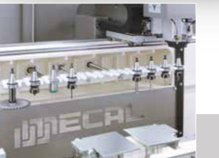
El almacén de herramientas de 11 posiciones situado en el centro de la base le permite optimizar los tiempos de cambio de herramienta. Puede contener herramientas para fresado, roscado, de cara al final de fresado y también cabezas angulares para el mecanizado de los extremos del perfil
