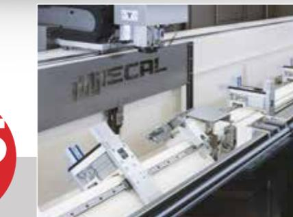
Las murazas se deslizan sobre guías lineales de precisión y se pueden colocar automáticamente por el montante móvil (versión DPM), o con motor independiente en cada muraza (variante MMI)
