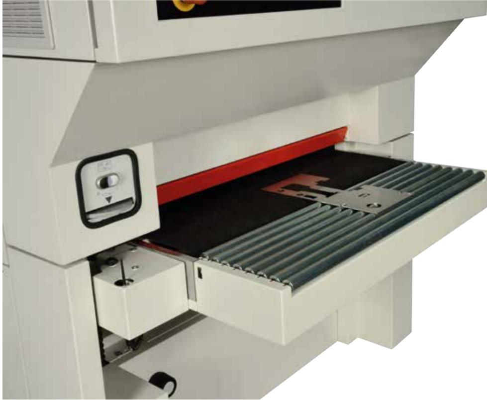
O transportador de rolos na entrada e saída para a máquina consiste em rolos soltos, obtidos a partir de barras de aço estiradas e encostadas, que permite resistir à corrosão de óleos e cargas de trabalho pesadas.
